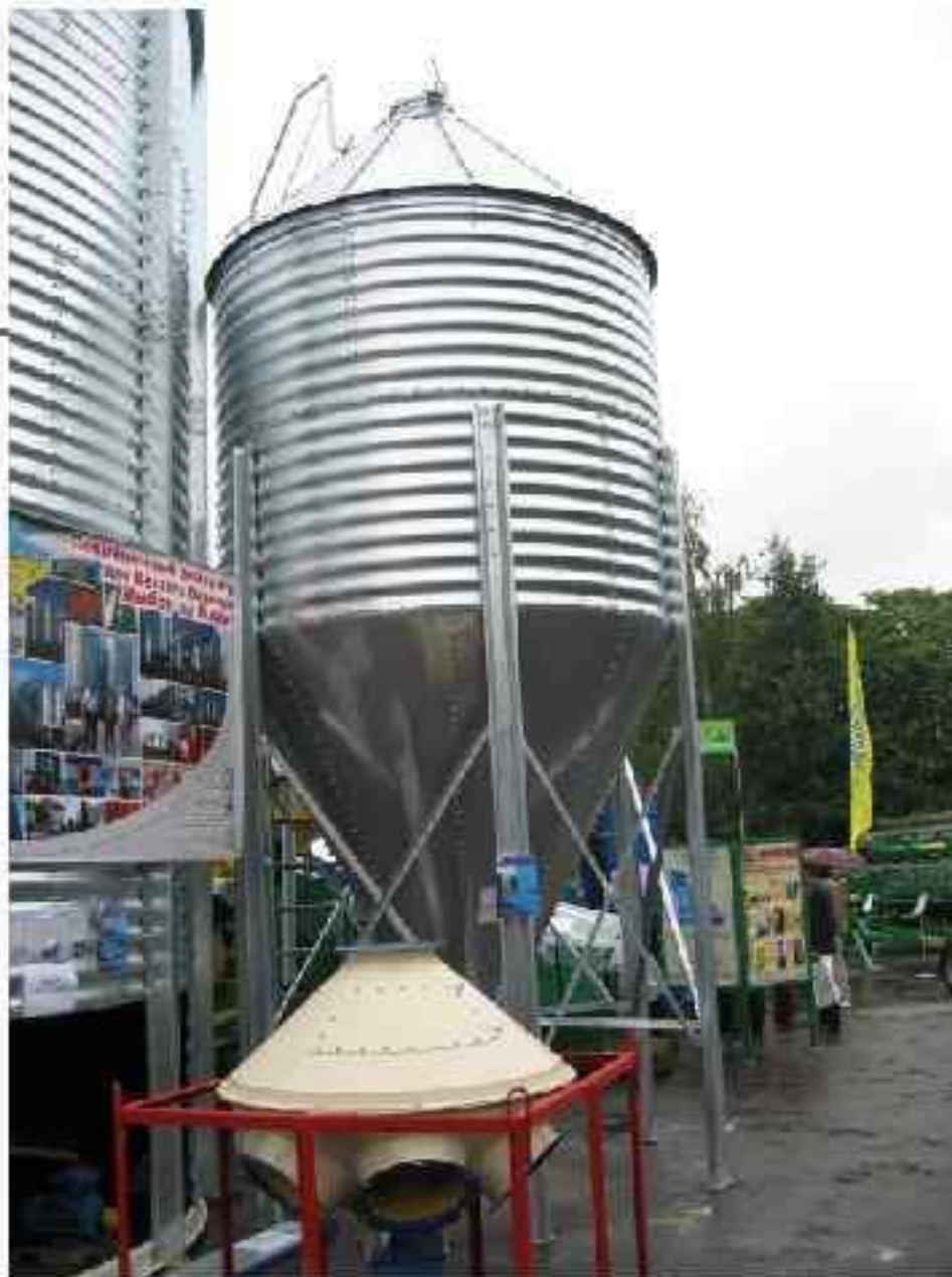
Бункер активного вентилявання БВ-25
